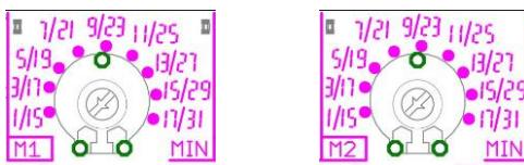
Mediante il trimmer “MIN” è possibile regolare la corrente minima del motore per la protezione contro la marcia a secco nel caso si volesse un ulteriore protezione o non si volessero utilizzare sonde o galleggiante di minimo livello.
