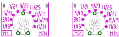
Mit dem Trimmer „MIN“ kann zum Schutz vor Trockenlauf der Mindeststrom des Motors eingestellt werden, falls ein zusätzlicher Schutz gewünscht ist oder keine Mindestfüllstandssonden oder Mindestfüllstandsschwimmer verwendet werden sollen.
